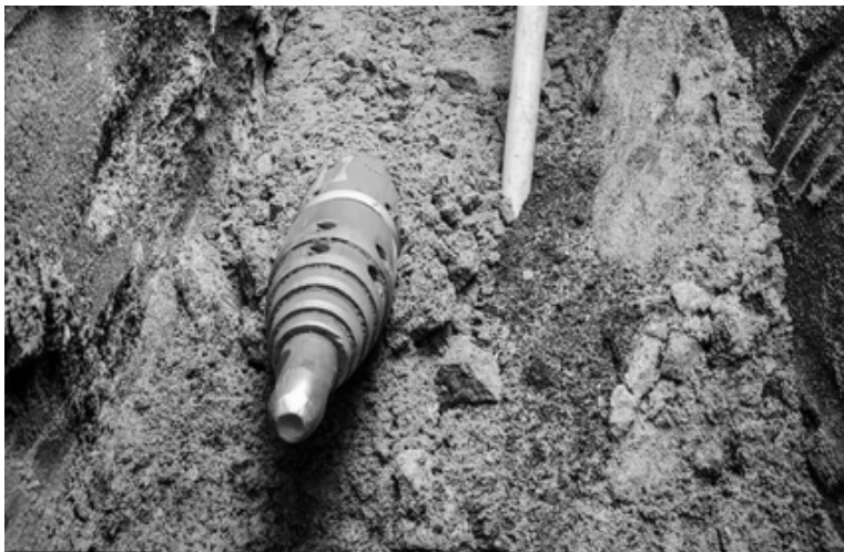
Rys. 27. Kret ciągnący rurę
