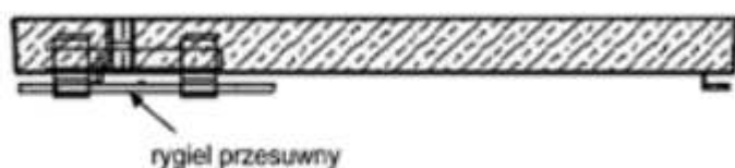
Rys. 7. Pokrywa z rygłem przesuwным
